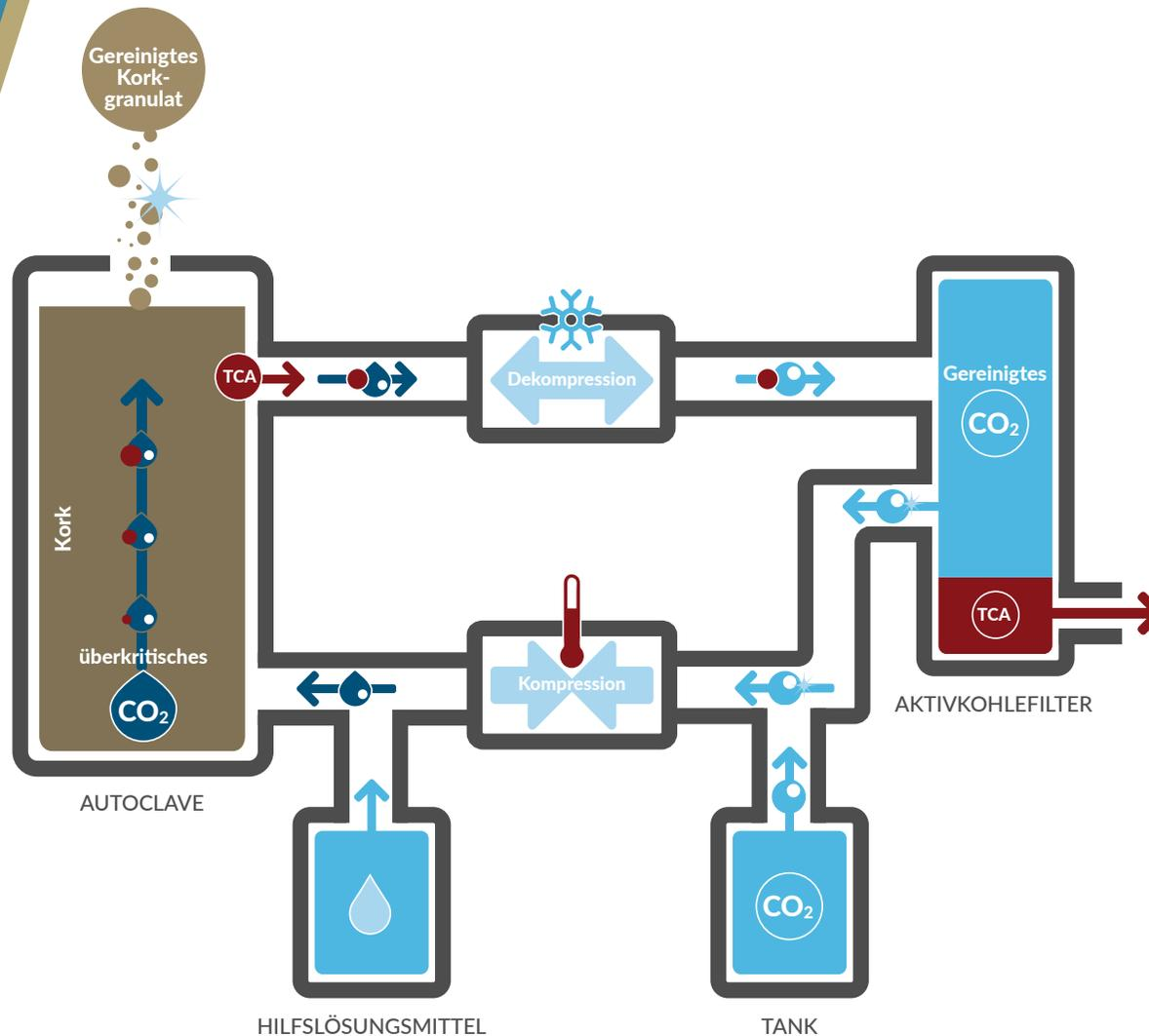
Die Reinigung mit superkritischem CO<sub>2</sub> ist bereits aus anderen Anwendungen bekannt. Die Zusammenarbeit mit dem CEA hat ermöglicht, die Diamant® Technologie zu entwickeln, ein exklusives Verfahren zur Reinigung von Kork.
